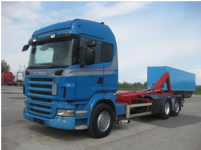
Obrázek č. 2: Ukázka automobilového nosiče hákových kontejnerů
