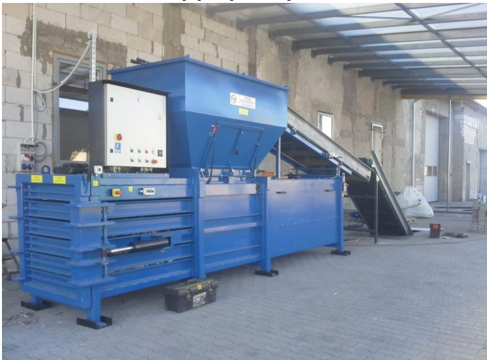
Obrázek č. 9: Ukázka lisu na papír a plast s dopravníkem
